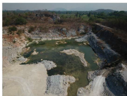
บริเวณจุดต่ำสุดที่เป็นบ่อรับน้ำ (Sump)
